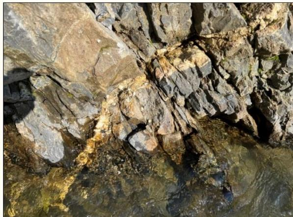
Образец, отобранный из окварцованной зоны с медной зеленью и крупными гнездами сфалерита
